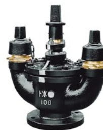
JWVA B 103 地下式双口消火栓 100mm ●水道用地下式双口消火栓 ●旧型 ●FC/内面 JWVA K 139(黒) ■試験圧力 本体1.72MPa 弁座1.27MPa
